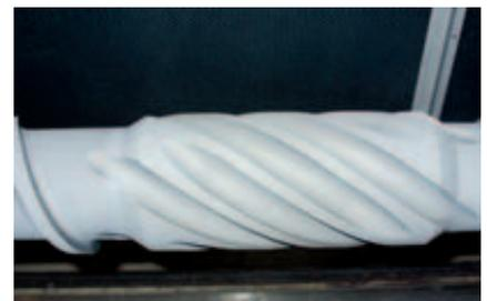
Äußerst widerstandsfähig: Nanobeschichtete Extruderschnecke
