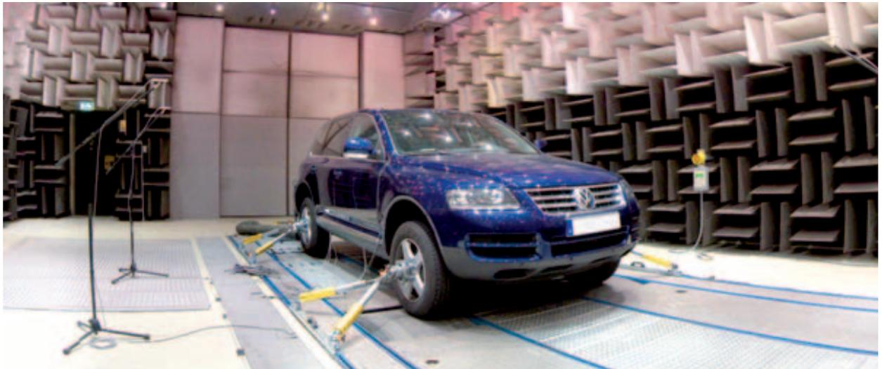
Faist Chem Tec verfügt über einen hochmodernen Allrad-Rollenprüfstand im akustischen Halbfreifeldraum.
