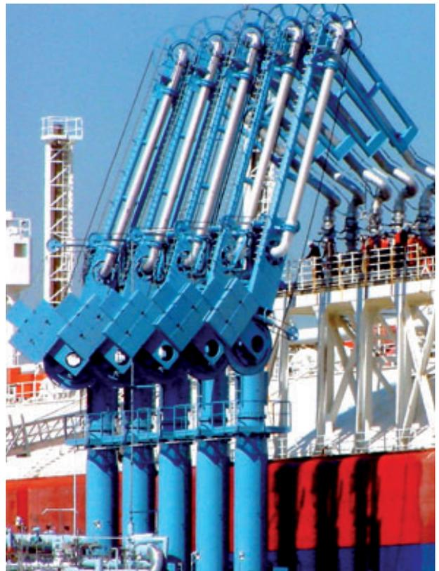
Kernprodukt von SVT sind explosionsgeschützte Anlagen zum Verladen von Flüssiggas.
