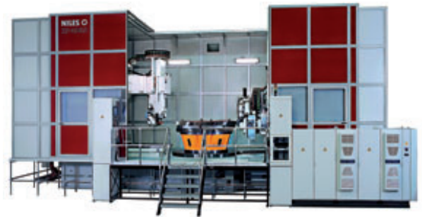
Nimm zwei: Die Zweitständermaschine ermöglicht ein Umstellen von Außen- auf Innenverzahnung ohne Umrüstzeit. Foto: Niles Werkzeugmaschinen, Berlin
