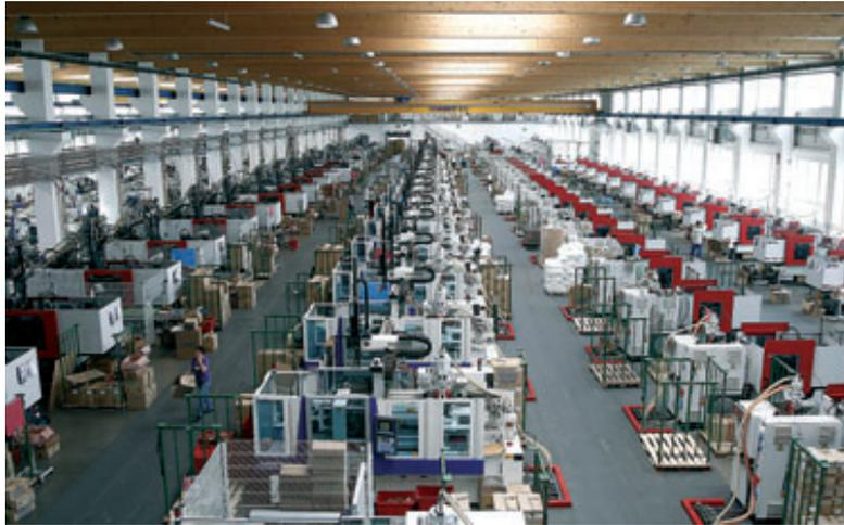
Das Spritzereigebäude am Produktionsstandort Dietenhofen mit 125 von insgesamt über 400 Maschinen.
